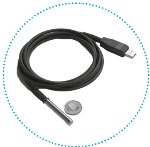
Der neue OHT20 Sensor misst die relative- Feuchte, Temperatur, Taupunkt und die absolute- Feuchte. Er wird direkt am USB Port eines PCs betrieben. Der OHT20 wird in 3 Ausführungen angeboten Typ A, B oder C. Der Typ A hat bei Feuchte eine Genauigkeit von  $\pm 1,5$  % RH und bei Temperatur eine Genauigkeit von bis zu  $\pm 0,1$  °C. In Verbindung mit der mitgelieferten Messwerterfassungssoftware bildet es ein sehr flexibles und präzises Messsystem mit Datalogger Grenzwertüberwachung.
